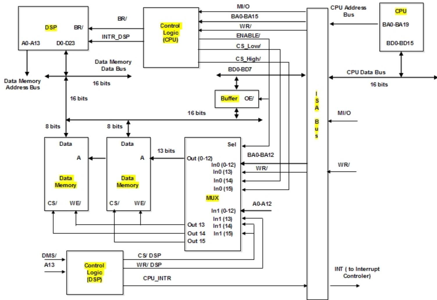
Schema de principiu a placii RK2105
