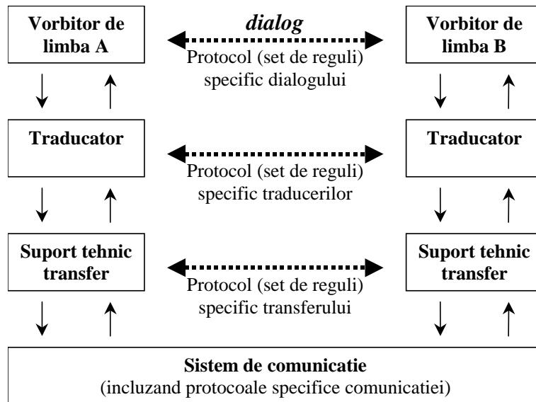
Un sistem de comunicatie stratificat utilizeaza acelasi model, bazat pe **niveluri si protocoale** de comunicatie.
